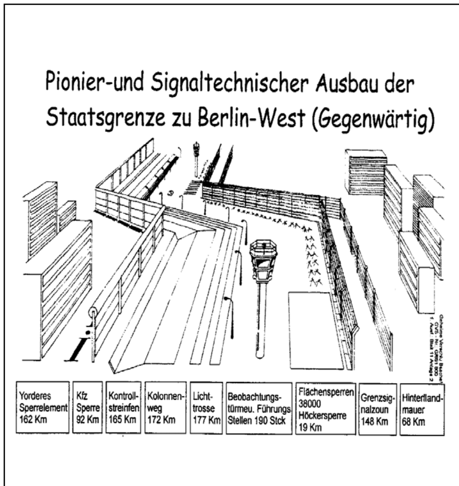
Fig A-10. Ilustração de documento da ex-República Democrática Alemã ("Execução técnica de engenharia e comunicações da fronteira para Berlim Ocidental"), que mostra a grandiosidade do "muro" de Berlim - quilometragem dos anteparos anteriores, dos fossos para viaturas, da faixa de controle, do caminho para patrulhas, das faixas minadas, das cercas de sinalização, do muro posterior... A propaganda comunista procurava persuadir que a referida obra tinha por finalidade impedir que o pessoal do "inferno capitalista" fugisse para aquele "paraíso socialista".
